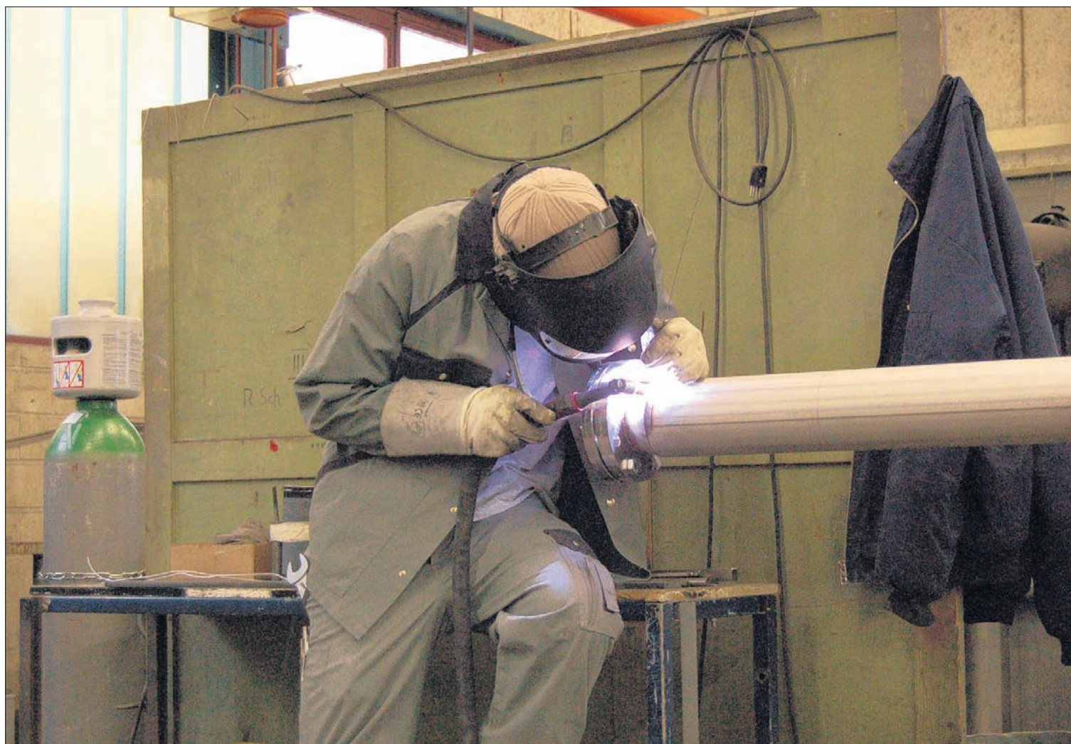
Jonathan Panier, Lernender Anlagen- und Apparatebauer EFZ im 3. Lehrjahr, schweisst einen Konus auf ein Chromnickelstahlrohr.
