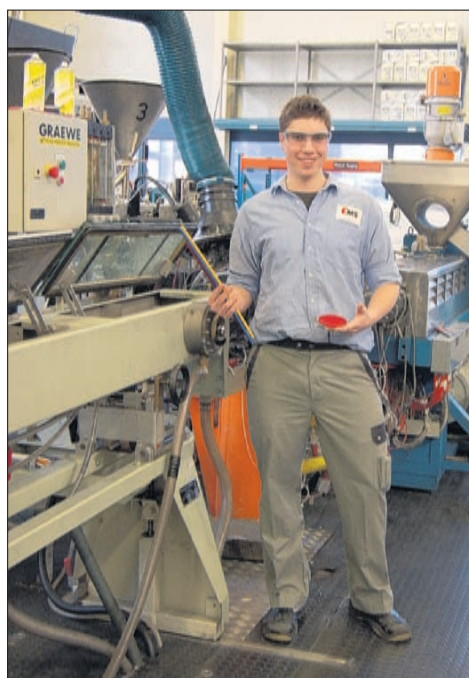
Emanuel Hirscher bei der Anlage zur Herstellung von Glattröhren. Diese werden zum Beispiel als Benzinleitungen eingesetzt.
